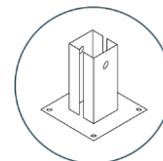
Fixation platine (FC) / Jambe de scellement (FL)
